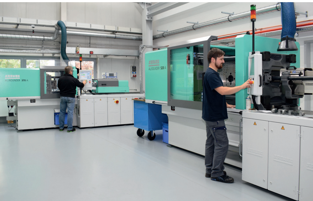
Günther hat in seinem Technikum unlängst zwei neue Spritzgießmaschinen für Kundenversuche installiert. © Günther
